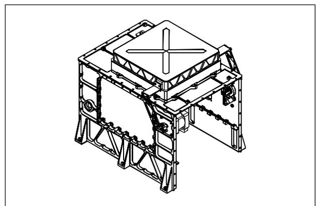
Fig. 4: GIADA Instrument
